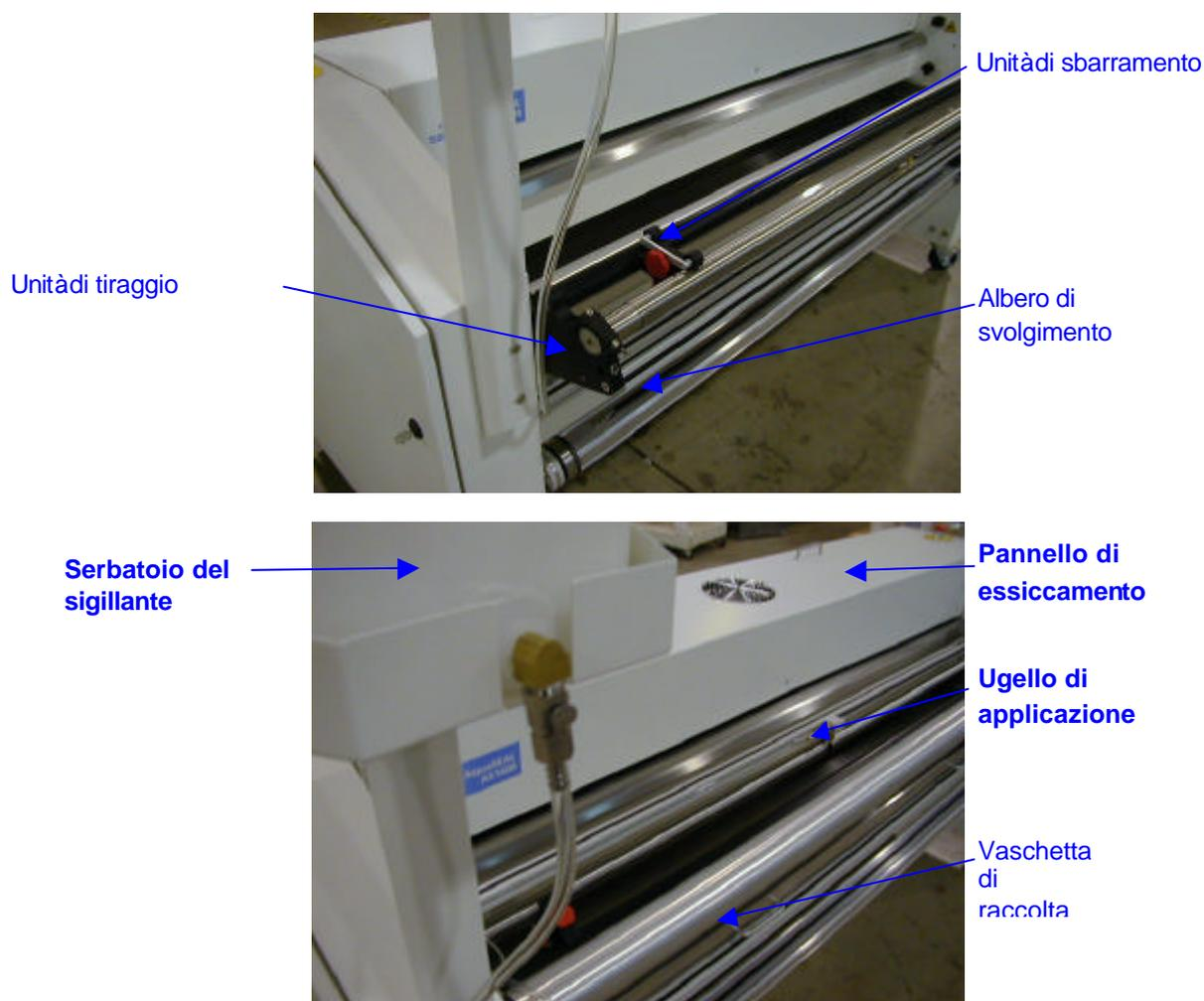
**Figura 1.1** Vista frontale del laminatore liquido *AquaSEAL™ AS-1600*
