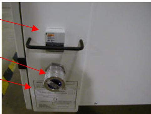
Fig 1.3 – Ingresso del cavo di alimentazione, interruttore e piastrina di identificazione
