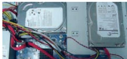
3) Capovolgere il case e fissare gli HDD con le viti, quindi rimontare il coperchio superiore.
