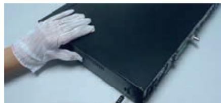
2) Collocare l'HDD sul fondo del case e collegare i cavi di alimentazione e dati.
