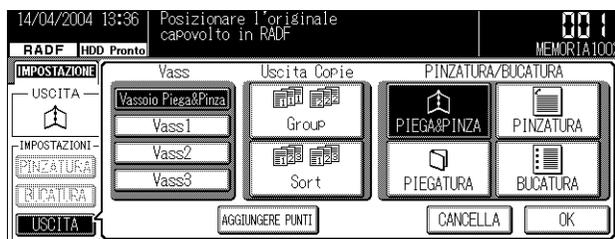
Selezionando **PIEGATURA** o **PIEGA&PINZA** viene automaticamente selezionato il vassoio pinzatrice a sella.
