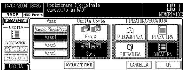
Per visualizzare il menu di scelta rapida di selezione dell'ubicazione della pinzatura, sfiorare due volte **PINZATURA**.
