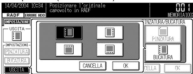
Menu di scelta rapida di selezione dell'ubicazione della pinzatura (finisher FS-114 + kit pinzatura a sella SK-114)
