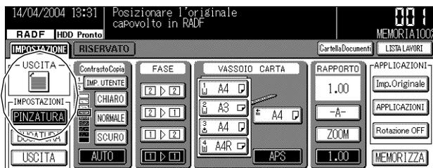
L'icona della posizione di pinzatura verrà visualizzata nell'area dell'icona USCITA. Se viene utilizzato il finisher FS-114, inizialmente verrà selezionato il vassoio 1, mentre il vassoio primario (principale) verrà sistemato quando viene utilizzato il finisher FS-113.
