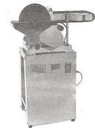
Fig. 5 Montaggio del supporto e del corpo Posizionare il corpo sul supporto, ricordare di far corrispondere i quattro fori del coperchio con i quattro fori filettati del corpo. Estrarre i bulloni e le rondelle (G) dall'involucro dei componenti hardware per fissare il supporto e il corpo come in Fig. 5.
