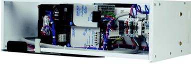
**IMPORTANTE** Per consentire il corretto funzionamento del sistema di cablaggio DeviceNet, occorre un'alimentazione a 24V CC. L'alimentatore **deve** essere compatibile con DeviceNet secondo quanto specificato nei requisiti della ODVA.
