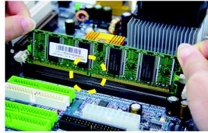
2. Inserire il modulo di memoria DIMM verticalmente nello slot DIMM. Quindi spingerlo verso il basso.
