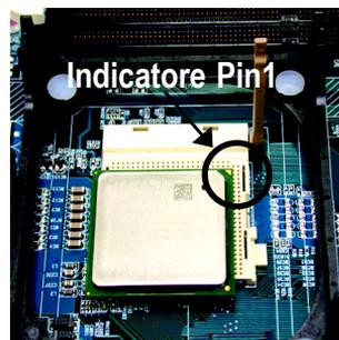
4. Localizzare il Pin 1 nello slot ed individuare l'angolo smussato (dorato) nella parte superiore della CPU. Quindi inserire la CPU nello slot.
