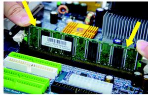
3. Chiudere i fermagli di plastica da entrambe le estremità degli slot DIMM per bloccare il modulo DIMM. Invertire le fasi di installazione se si desidera rimuovere il modulo DIMM.
