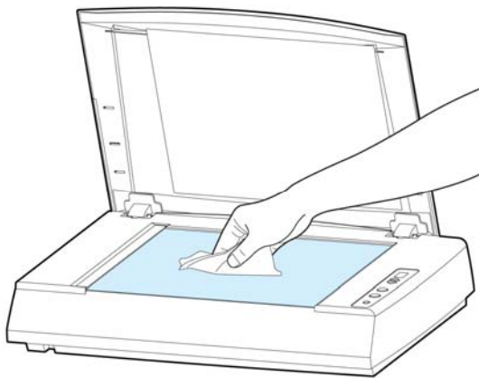
Figura 7-1 La pulizia dell'area
