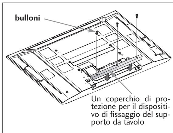
Per impedire che materiale estraneo entri nel dispositivo di fissaggio del supporto da scrivania, fissare il coperchio di protezione usando i bulloni forniti, come mostrato nella figura.
