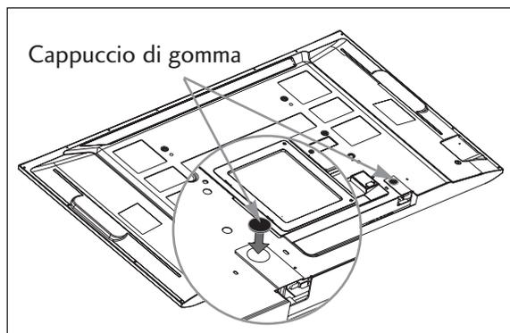
Se non si adopera il supporto da tavolo, si prega di installare i cappucci di gomma per proteggere il dispositivo di fissaggio del supporto come mostrato in figura.
