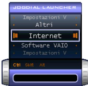
La finestra di Center Jog Control si trova in modalità di avvio finché non si avvia un'applicazione o la finestra di Center Jog Control non diviene attiva. Quando compare una freccia accanto a una voce nella finestra di Center Jog Control, è possibile visualizzare un sottomenu relativo a tale voce selezionando la freccia e premendo Center Jog Control.
