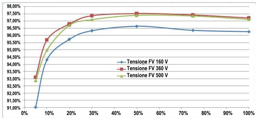
Figura A-2 Curve di efficienza Conext 4000 E-S
