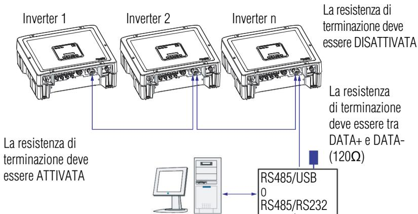
**Figura 2-37** Cablaggio RS485: più inverter
