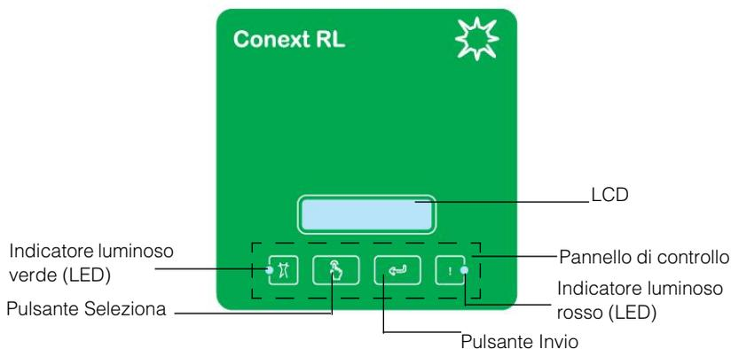
**Figura 3-1** Display LCD e pannello di controllo
