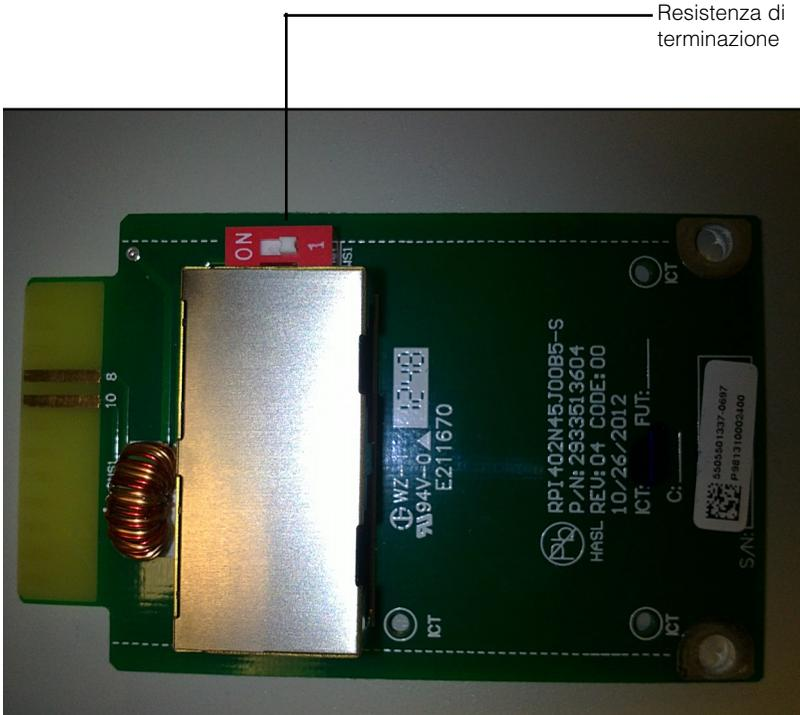
Figura 2-39 Resistenza di terminazione — numerazione interruttori
