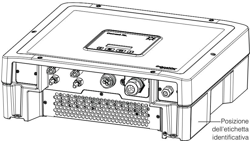
**Figura 2-10** Posizione dell'etichetta identificativa - Conext RL 3000 E
