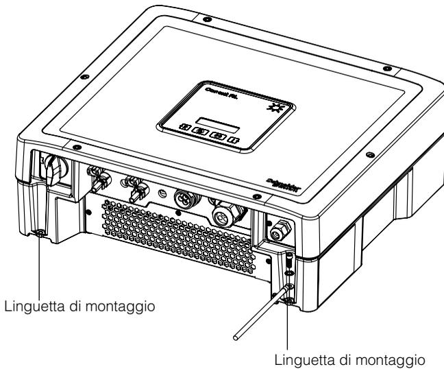
**Figura 2-23** Posizione delle linguette di montaggio (per fissare la parte inferiore dell'inverter alla piastra di montaggio)
