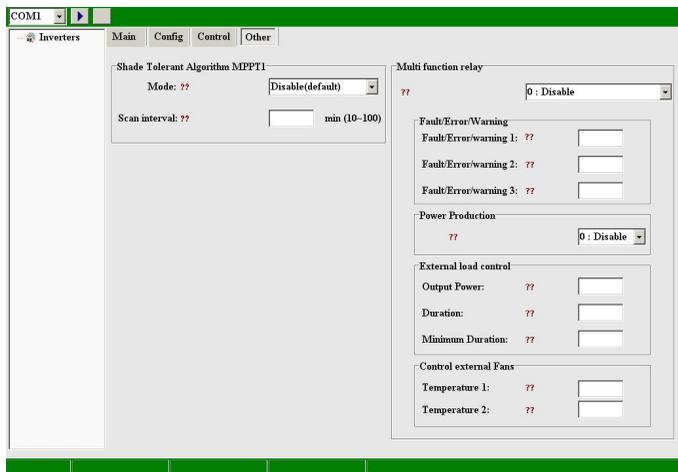
Figura 3-14 Impostazione di configurazione del relè multifunzione
