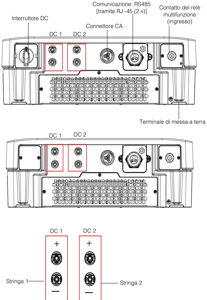
**Figura 1-11** Pannello di interfaccia - Conext RL 3000 E-S/3000 E
