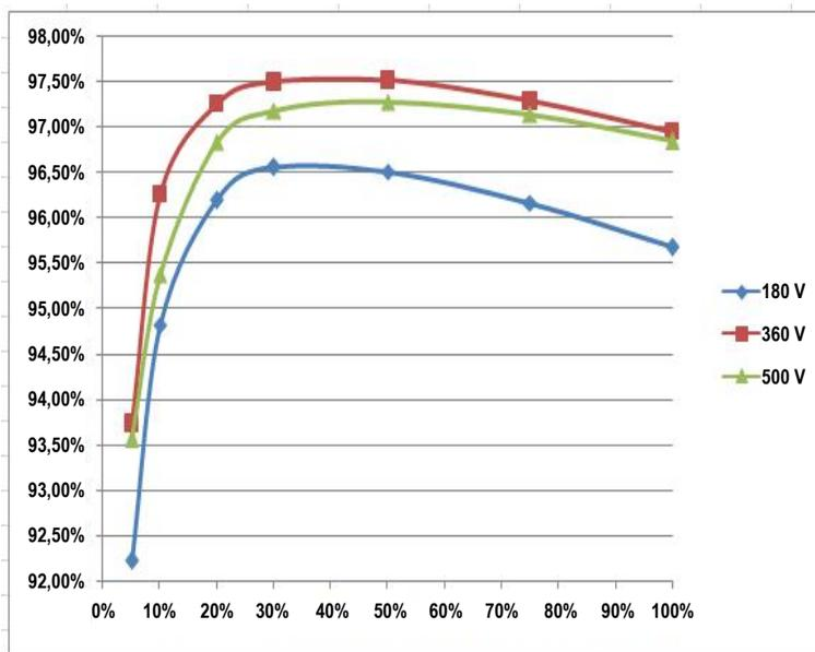
Figura A-3 Curve di efficienza Conext 5000 E-S
