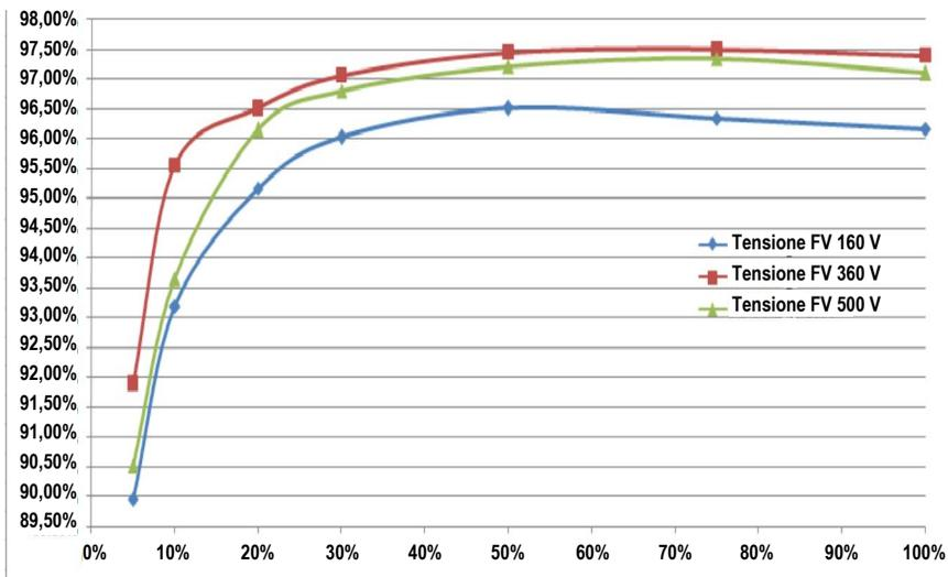
Figura A-1 Curve di efficienza Conext 3000 E-S
