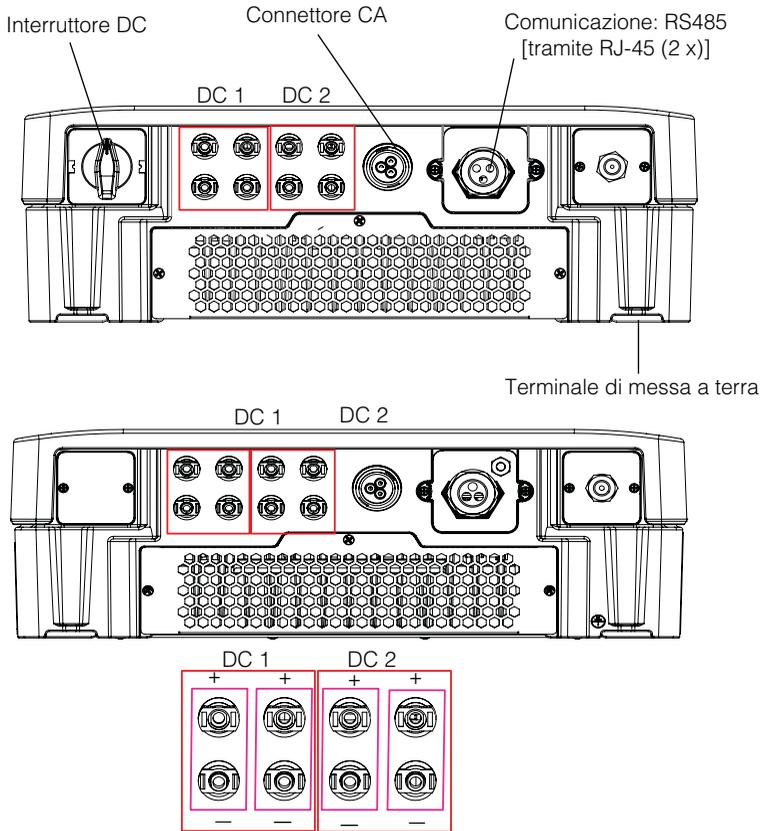
**Figura 1-12** Pannello di interfaccia - Conext RL 4000 E-S/5000 E-S e Conext RL 4000 E/Conext RL 5000 E
