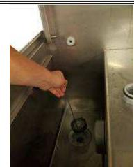
Rimuovere e pulire il filtro secondario, posto sul fondo della vasca di lavaggio (*macchine con pompa di scarico*).
