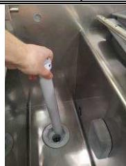
Rimuovere il tappo dello scarico (*macchine con scarico gravitazionale*).
