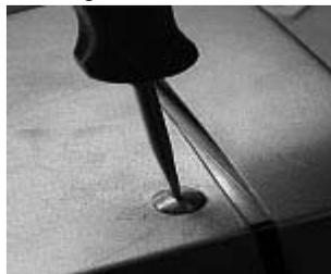
3. Aprire il telaio posteriore e togliere le due viti dal telaio e aprirlo
