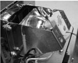
6. Chiudere bene il telaio. Utilizzando un cacciavite a punta piatta spingere e avvitare le due viti del telaio superiore di ¼ di giro in senso orario.
