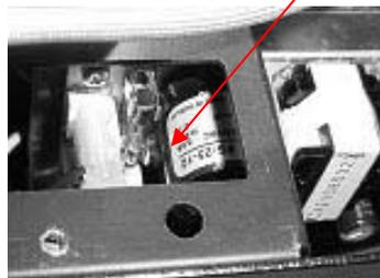
5. Rimettere il telaio. Prima di chiuderlo controllare che lo sportello sia correttamente inserito nelle aperture del pannello anteriore.
