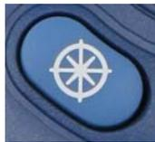
Consente di passare direttamente alla vista Orientamento. Questa funzione consente di misurare la direzione (azimut) dell'array di pannelli solari nonché l'inclinazione dell'array o quella del tetto.
