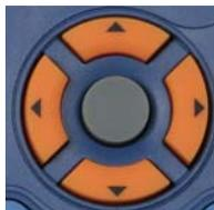
Il tasto di navigazione a cinque direzioni può fungere da input per molte delle funzioni di navigazione visualizzate sullo schermo di SunEye. Ad esempio, è possibile utilizzare il tasto di navigazione a cinque direzioni per scorrere i menu:
