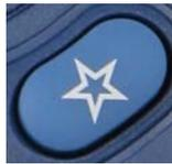
Consente di passare direttamente alla modalità di ispezione del sito e prepara SunEye allo scatto di un'istantanea della linea di visibilità del cielo.
