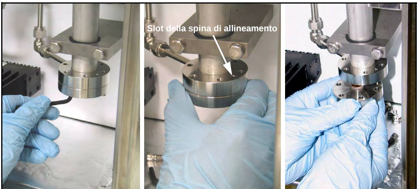
Figura 73: Rimozione dello specchio dell'unità Aurora H 2 O
