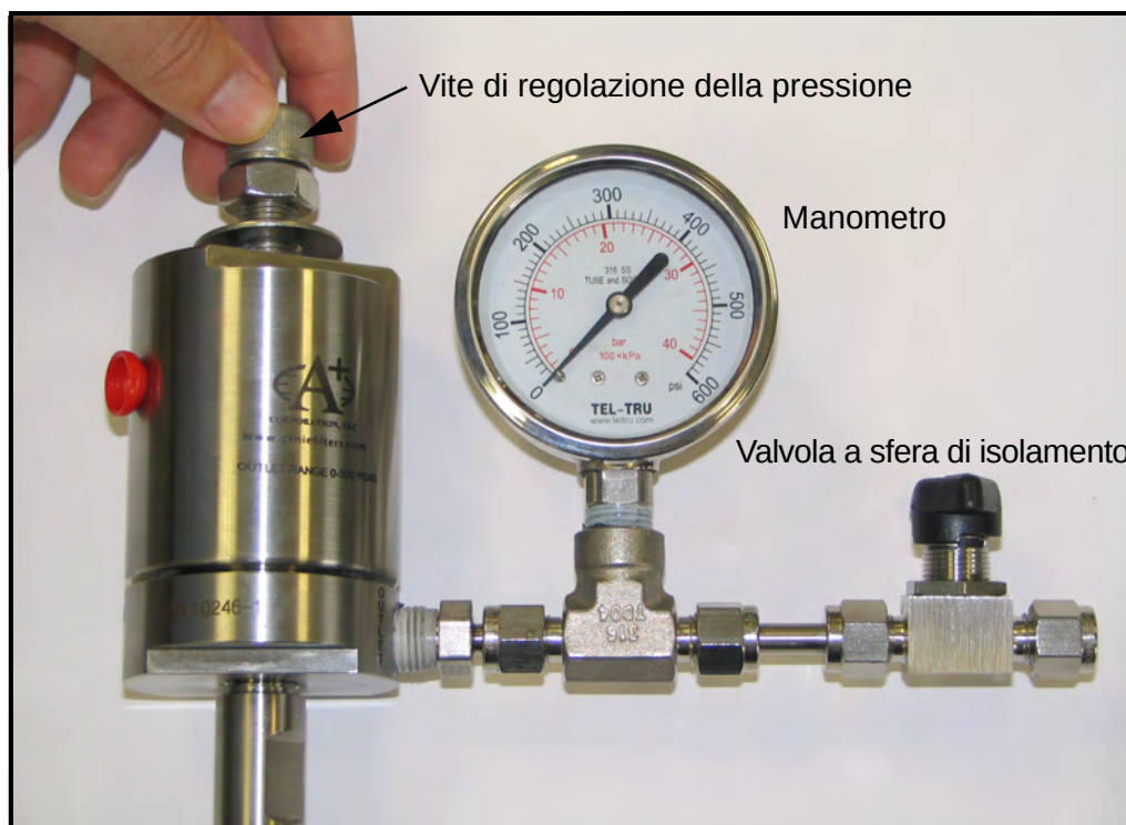
Figura 16: Rotazione della vite di regolazione della pressione
