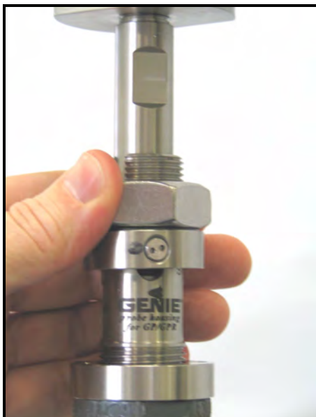
Figura 21: Serraggio del dado di inserimento
