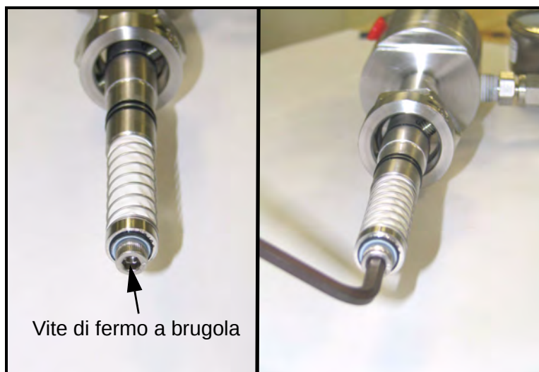
Figura 15: Controllo/serraggio della vite di fermo a brugola
