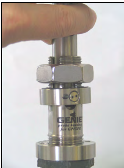
Figura 19: Rotazione della sonda
