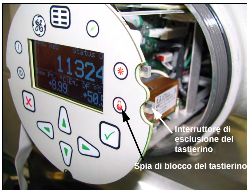
Figura 36: Posizione dell'interruttore di esclusione del tastierino
