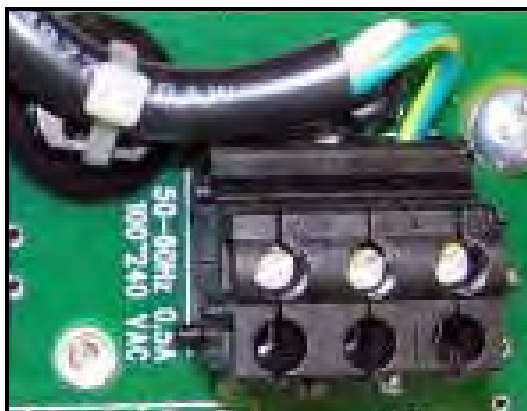
Figura 25: Morsettiera di alimentazione
