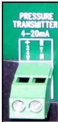
Figura 28: Connessioni del trasmettitore di pressione
