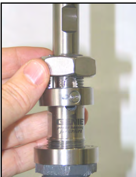
Figura 20: Allentamento del dado di inserimento
