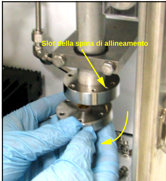
Figura 80: Reinstallazione del gruppo specchio
