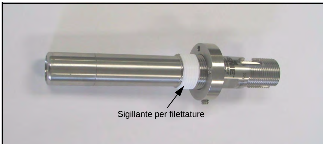
Figura 10: Applicazione del sigillante per filettature
