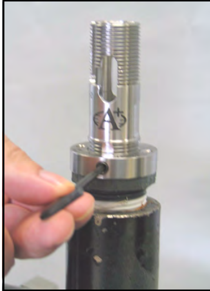
Figura 13: Allineamento e serraggio della vite a brugola
