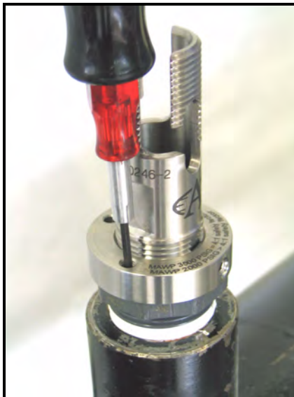
Figura 14: Serraggio delle viti a brugola
