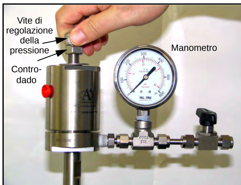
Figura 22: Rotazione della vite di regolazione della pressione
