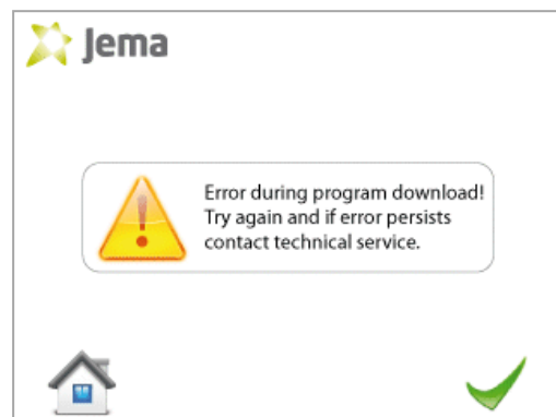
Schermata di errore nella riprogrammazione del controllo
