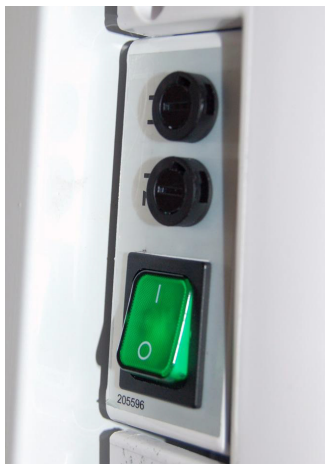
Interruttore di accensione e fusibili principali
