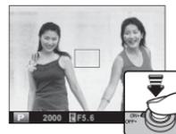
◆ Se si seleziona **ON/OFF BL. AE/AF** per **AE-L** **MOD. BLOCCO AE/AF** (☰ 78), messa a fuoco e/o esposizione vengono bloccate quando si preme il pulsante **AFL/AEL** e rimangono bloccate finché non si preme di nuovo il pulsante.
