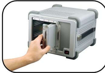
**5** Il dispositivo DAQ è pronto per essere inserito nello chassis di uno strumento.
