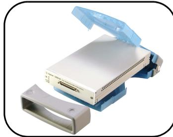
**2** Estrarre il dispositivo DAQ dalla custodia di plastica tirando il piede della protezione in gomma (lato anteriore della custodia) verso l'esterno, quindi, sollevare l'involucro di plastica e toglierlo dal dispositivo DAQ.
