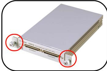
**3** Utilizzando un cacciavite *Philips*, svitare il kit di montaggio a L dal dispositivo DAQ.
