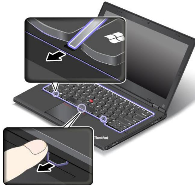
6. Inserire l'estremità piatta del multistrumento della tastiera negli spazi intorno ai tasti come mostrato per far scorrere la struttura della tastiera in avanti. Verificare che non rimanga dello spazio tra la struttura della tastiera e la relativa mascherina.
