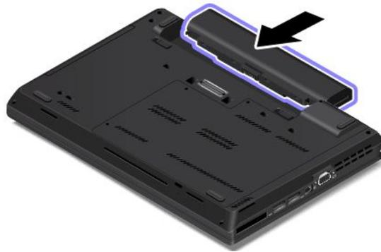
Dopo la sostituzione, capovolgere il computer e collegare l'adattatore di alimentazione CA e tutti i cavi al computer.
