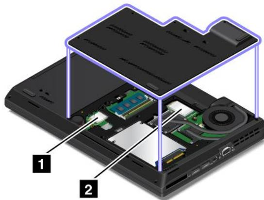
**Nota:** utilizzare per il computer solo schede di comunicazione wireless autorizzate da Lenovo. Se si installa una scheda di comunicazione wireless non autorizzata, ossia non approvata per l'utilizzo con il proprio computer, verrà visualizzato un messaggio di errore e il computer emetterà un segnale acustico quando viene acceso.
