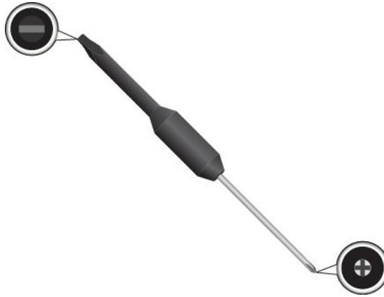
4. Per rivelare le teste delle viti sotto la struttura della tastiera, utilizzare l'estremità piatta del multistrumento per far scorrere tale struttura in avanti di 2,5 mm.
