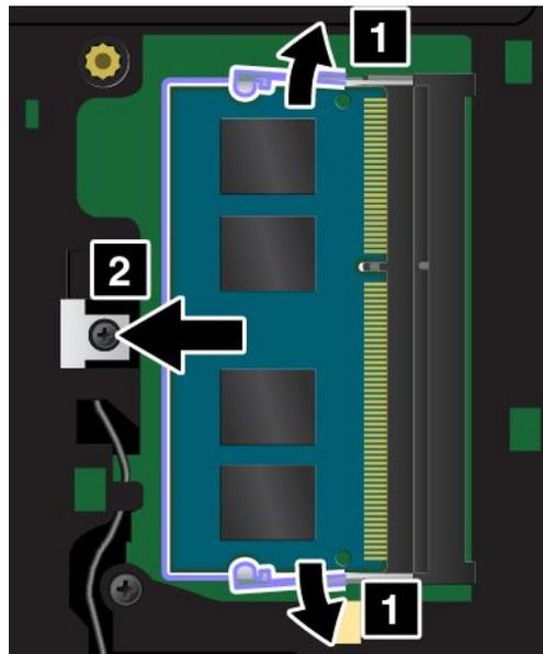
5. Posizionare l'estremità con l'incavo del nuovo modulo di memoria rivolta verso il bordo di contatto dello slot di memoria e inserire il modulo di memoria **1** nello slot con un angolo di circa 20 gradi. Ruotare il modulo di memoria verso il basso finché non scatta in posizione **2**. Verificare che il modulo di memoria sia installato saldamente nello slot e che non possa essere rimosso facilmente.
