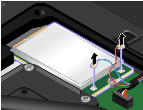
5. Rimuovere la vite. La scheda viene rilasciata dalla posizione di sicurezza e viene ruotata verso l'alto.
