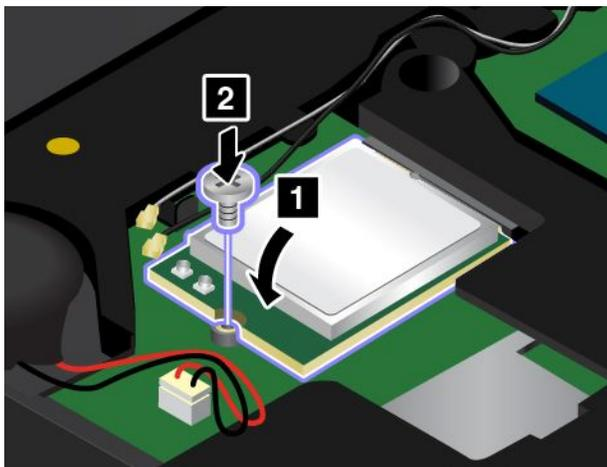
7. Collegare i cavi dell'antenna alla nuova scheda WLAN (wireless LAN). Accertarsi di collegare il cavo grigio al connettore principale sulla scheda e il cavo nero al connettore ausiliario sulla scheda.
