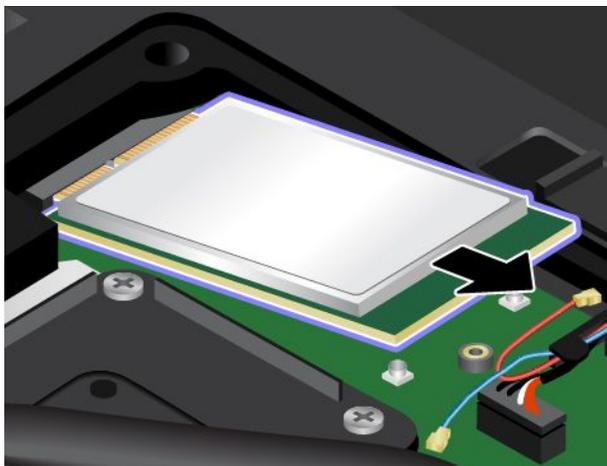
7. Allineare l'estremità con l'incavo della nuova scheda WWAN con la chiave nello slot. Inserire quindi con cautela la scheda nello slot con un angolo di circa 20 gradi.
