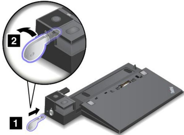
3. Allineare l'angolo superiore sinistro del computer con il segno della posizione della stazione di espansione. Inserire il computer nella stazione di espansione verticalmente finché non si sente uno scatto **1**. Il computer viene collegato alla stazione di espansione. Girare quindi il tasto di blocco sistema in posizione di blocco **2**.
