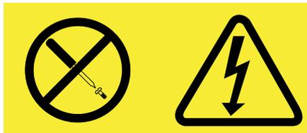
Qualsiasi parte recante tale etichetta presenta livelli pericolosi di energia, corrente o voltaggio. All'interno di tali componenti non vi sono parti riparabili dall'utente. Se si sospettano problemi relativi a uno di questi componenti, contattare il tecnico dell'assistenza.
