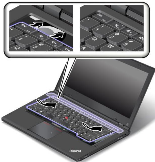
3. Verificare che le teste delle viti siano esposte correttamente. In caso contrario, rivelare le teste delle viti facendo scorrere la struttura della tastiera in avanti con l'estremità piatta del multistrumento della tastiera.
