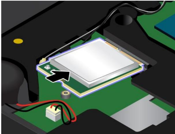
6. Ruotare la nuova scheda WLAN (wireless LAN) verso il basso **1**, quindi installare la vite per fissare la scheda in posizione **2**.
