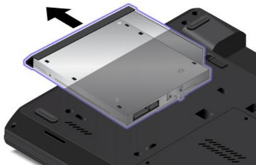
5. Inserire il dispositivo Ultrabay sostituibile nel vano.
