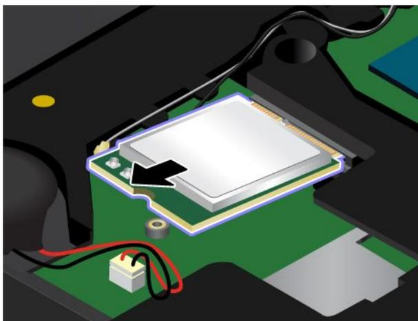
5. Allineare l'estremità con l'incavo della nuova scheda WLAN (wireless LAN) con la chiave nello slot. Inserire quindi con cautela la scheda nello slot con un angolo di circa 20 gradi.
