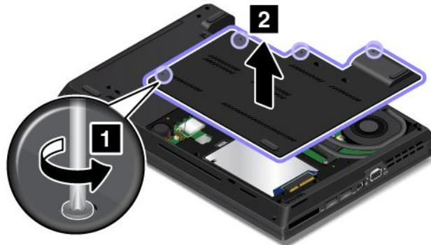
4. Se si sta installando una scheda WLAN (wireless LAN), procedere con il passaggio 5. Se si sta sostituendo una scheda WLAN (wireless LAN), procedere come segue per rimuovere prima la scheda precedente:
