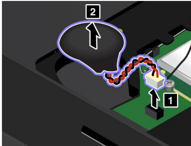
5. Installare la nuova batteria in formato moneta **1** e collegare il connettore **2**.
