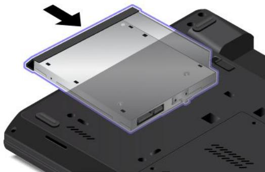
6. Installare la vite per fissare il nuovo dispositivo Ultrabay.
