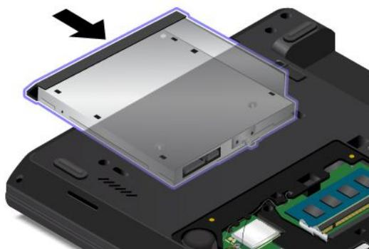
7. Installare la vite per fissare il nuovo dispositivo Ultrabay.
