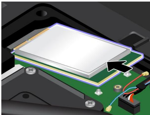
8. Ruotare la nuova scheda WWAN verso il basso **1**, quindi installare la vite per fissare la scheda in posizione **2**.
