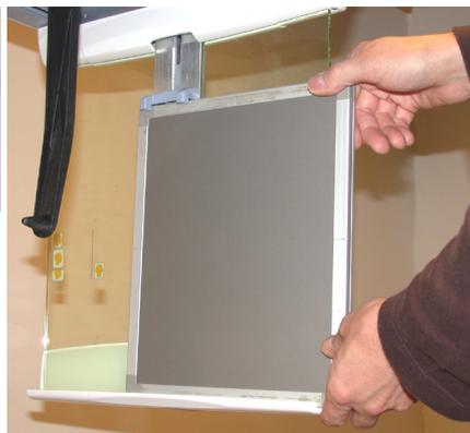
Fig 3.6. Orientamento della cassetta per esposizioni cefalometriche
