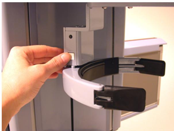
Fig 3.4. Spostamento del supporto per la testa in avanti
