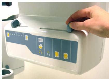
Fig 6.9. Vista simmetrica, selezione del collimatore
