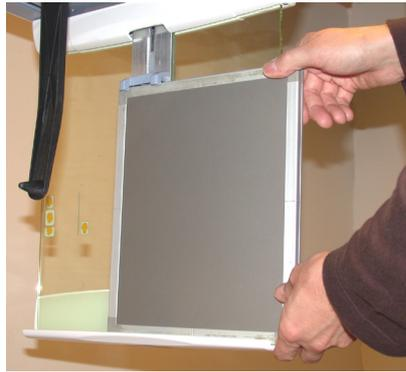
Fig 3.1. Rimozione della cassetta per esposizioni cefalometriche
