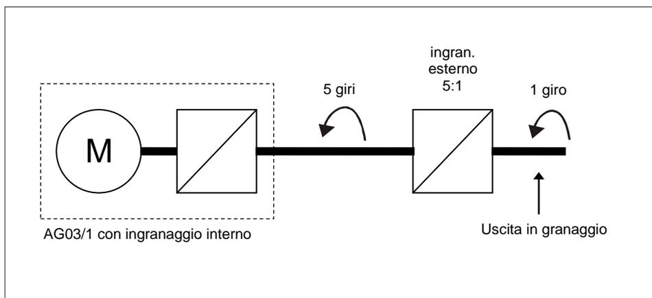
Fig. 7: ingranaggio esterno
