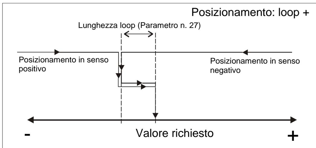
Fig. 3: posizionamento loop+
