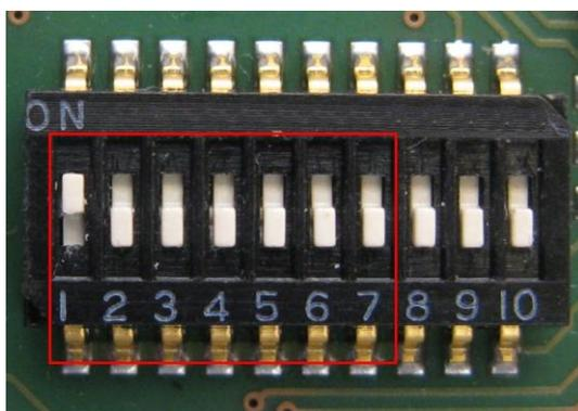
L'immissione dell'indirizzo slave avviene tramite gli interruttori 1 - 7 nel formato binario. L'impostazione dell'indirizzo 127 viene convertita internamente nell'indirizzo 126.
