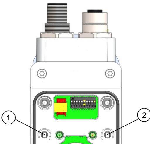
Servendosi dei tasti di comando è possibile avviare il modo di messa a punto manuale (corrispondente al modo passo-passo 2). Questo permette lo spostamento dell'attuatore senza controllore superiore.
