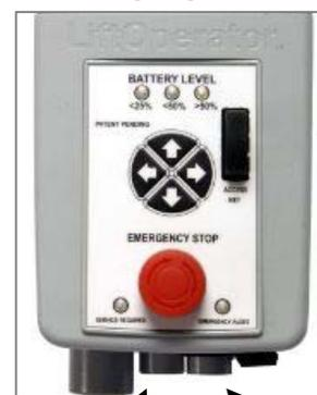
sicurezza consentendo il funzionamento del comando soltanto con l'utilizzo della stessa. L'unità comanda tutte le operazioni del sollevatore esattamente come il comando manuale dell'utente. Nella parte inferiore del pannello di controllo sono collegati tre cavi che consentono il funzionamento del sollevatore: il connettore più grande per il comando manuale, il connettore n. 1 per il cavo motore (striatura rossa), il connettore 2 per il cavo motore (striatura verde).
