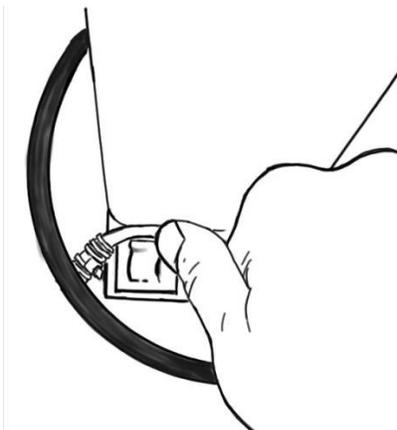
**A:** Fissare il filo nella clip inferiore del pilone.
