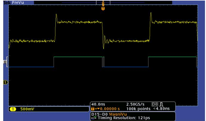
La registrazione ad alta risoluzione MagniVu consente una risoluzione di temporizzazione di 121,2 ps per effettuare misurazioni temporali critiche sulle forme d'onda digitali.
