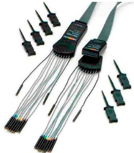
La sonda MSO P6316 offre due pod da otto canali per semplificare il collegamento al dispositivo.
