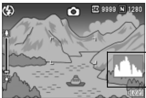
Osservando l'istogramma è possibile giudicare la luminosità di un'immagine senza l'influenza dovuta alla luminosità circostante lo schermo LCD. Esso aiuta inoltre a correggere le aree che sono eccessivamente chiare o scure.
