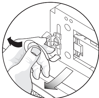
FIGURA 5-8 Tirare uno dei ganci fino a bloccare la testa in modo che non possa uscire
