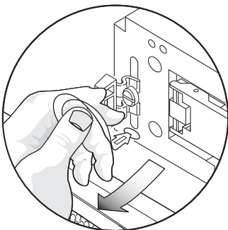
FIGURA 5-11 Tirare la testa del gancio completamente fuori dal telaio
