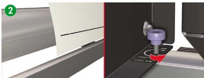
2. Dopo avere regolato l'altezza, controllare che il motivo sia allineato alla scanalatura sul bordo sinistro del supporto. Ripetere il passaggio due finché entrambe le estremità del motivo non risultano allineate alla stessa scanalatura.
