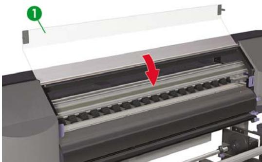
4. Estrarre il dispositivo di taglio (1) e i fermi del supporto (2) dal percorso del supporto, in modo che sia possibile accedervi per tagliare il supporto stampato e non danneggiare il bordo iniziale del supporto.
