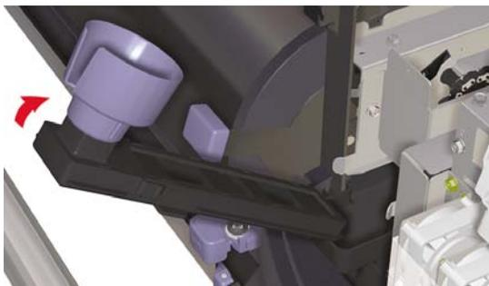
11. Aprire il coperchio di manutenzione del carrello, rimuovere la spugnetta del tergarrelli (1) e chiudere il coperchio.
