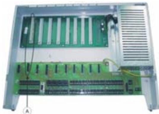
La scheda CPU va inserita, a centrale spenta, nello slot CPU (indicato con A in Figura 2). Tra le altre caratteristiche, la CPU comprende:
