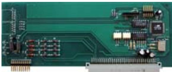
La scheda GSMCombi permette, in abbinamento al modulo Esse-ti GSM100, la connessione della centrale alla rete GSM. Sulla scheda è possibile installare fino a 2 moduli GSM100.
