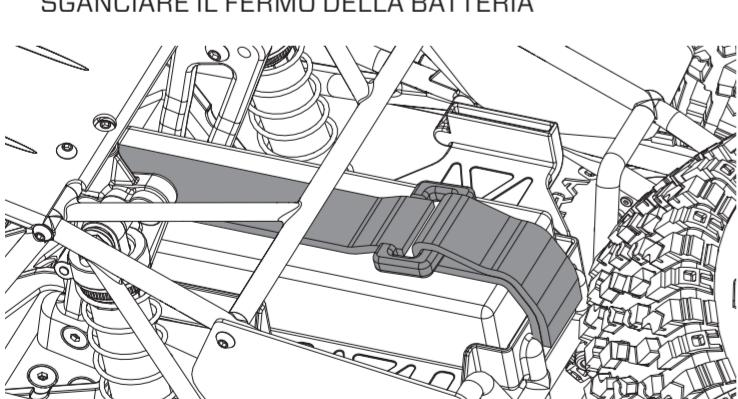
**5. TIGHTEN THE HOOK AND LOOP STRAP**
