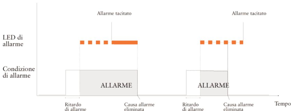
*Indicazione di allarme mediante LED.*
