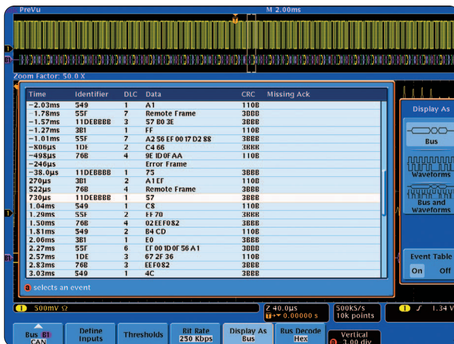
► Tabella di decodifica del pacchetto che mostra Identificatore, DLC, Dati e CRC decodificati per ogni pacchetto CAN una lunga acquisizione.
