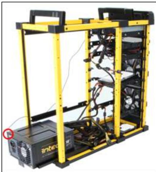
*Figura 29 – Fissaggio del cavo di messa a terra del pannello anteriore*
