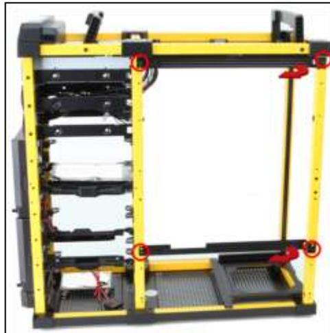
**Figura 19 –Rimozione delle guide del cassetto della scheda madre**
