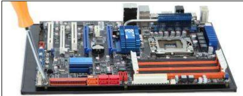
*Figura 25 – Fissaggio con viti della scheda madre dopo l'installazione dei blocchi*
