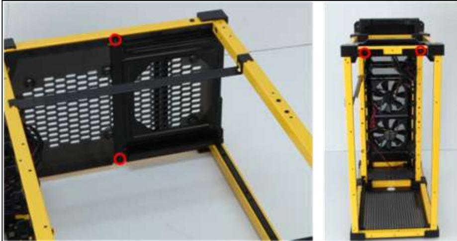
*Figura 21 – Ubicazione delle viti del supporto dell'alimentatore*
