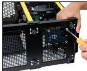
**Figura 13 – Fissaggio dell'unità da 2,5"**
