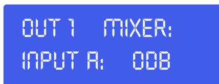
Regolare il mix volume per l'ingresso A agendo sul **jogwheel (8)**. Premendo il pulsante **opzione su (2)** sarà possibile procedere con l'opzione menu mixer. Nota: il menu mixer è attivato solo se i canali di ingresso non sono collegati.
