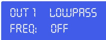
Regolare la frequenza di cut off agendo sul **jogwheel (8)**. Fare clic sul **jogwheel (8)** per passare al parametro successivo.
