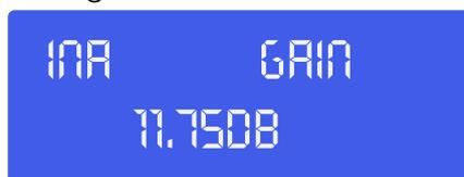
Regolare il gain agendo sul **jogwheel (8)**. Premere il pulsante **opzione su (2)** per passare all'opzione successiva. Nel nostro esempio si tratta del filtro Lowpass.
