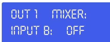
Regolare il mix volume per l'ingresso B A agendo sul **jogwheel (8)**. Premere il pulsante **opzione su (2)** per procedere con la configurazione del Delay.
