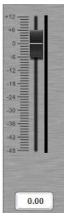
Il cursore gain indica l'impostazione reale di guadagno del canale. Il blocco di testo sotto al cursore del gain indica il valore esatto del gain. Consente di regolare il gain complessivo di ogni canale di uscita. Regolare il gain digitando il valore nella casella o facendo clic e trascinando il cursore.
