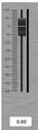
Il cursore gain indica l'impostazione reale di guadagno. Il blocco di testo sotto al cursore del gain indica il valore esatto del gain. Il cursore del gain consente di regolare il gain complessivo di ogni canale di uscita. Regolare il gain digitando il valore nella casella o facendo clic e trascinando il cursore.
