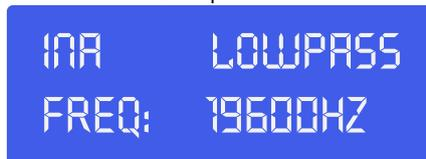
Regolare agendo sul **jogwheel (8)**. Sarà possibile disattivare il filtro lowpass ruotando il **jogwheel (8)** in senso orario fino a che la frequenza non supera i 20kHz. Fare clic sul **jogwheel (8)** per modificare il tipo di filtro.
