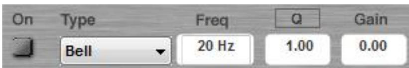
Entrambi i canali di ingresso hanno fino a 10 equalizzatori parametrici. Ogni equalizzatore parametrico può essere configurato come Allpass, Bell, High shelving, Low shelving o filtro Notch.
