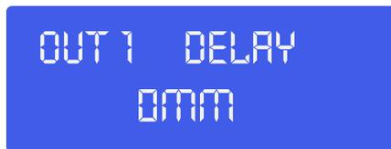
Fare clic sul **jogwheel (8)** per regolare il "delay" in mm, pollici o ms. Quindi, regolare il tempo di delay agendo sul **jogwheel (8)**. Premere il pulsante **opzione su (2)** per procedere con menu filtro Low Pass.
