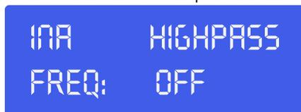
Regolare la frequenza di highpass agendo sul **jogwheel (8)**. Sarà possibile disattivare il filtro highpass ruotando il **jogwheel (8)** in senso anti-orario fino a che la frequenza non supera i 20Hz. Fare clic sul **jogwheel (8)** per selezionare un tipo di filtro.
