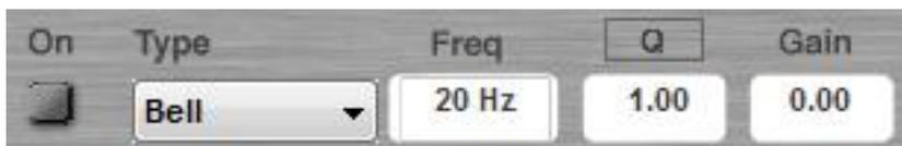
Entrambi i canali di ingresso hanno fino a 5 equalizzatori parametrici. Ogni equalizzatore parametrico può essere configurato come Allpass, Bell, High shelving, Low shelving o filtro Notch. Selezionare il tipo di filtro servendosi del menu a scorrimento verso il basso.
