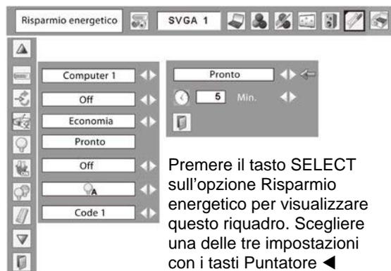
Premere il tasto SELECT sull'opzione Risparmio energetico per visualizzare questo riquadro. Scegliere una delle tre impostazioni con i tasti Puntatore ◀▶, passare al timer con i tasti Puntatore ▲▼ e impostare il tempo con i tasti Puntatore ◀▶.
