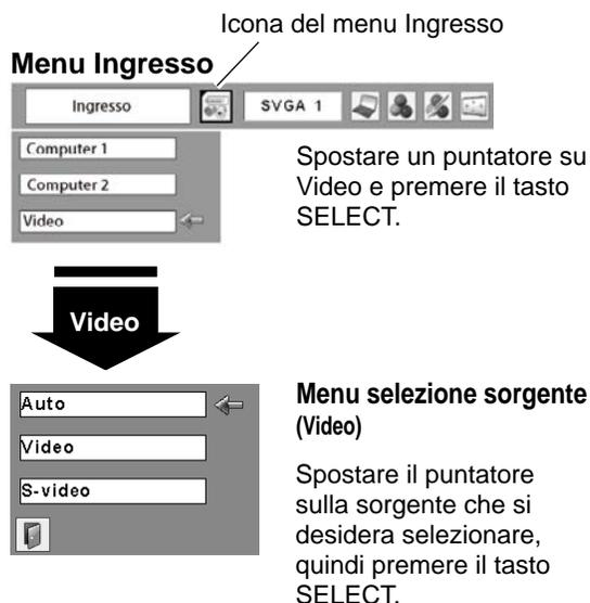
**Auto** Se si seleziona "AUTO" il proiettore rileva automaticamente il segnale video in ingresso ed esegue un'auto-regolazione per ottimizzare le prestazioni. Il proiettore seleziona i collegamenti nel seguente ordine:
