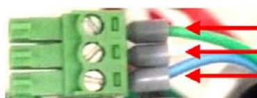
Figura 4 – Cablaggio connettore sensore di rete
