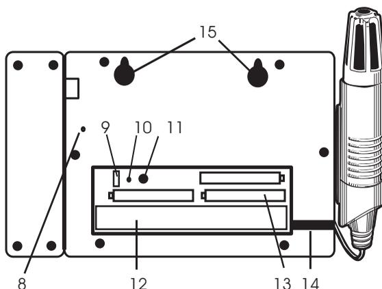
8. Tasto RESET DATI (azzerà i dati delle misurazioni memorizzate e la registrazione dell'allarme.)
