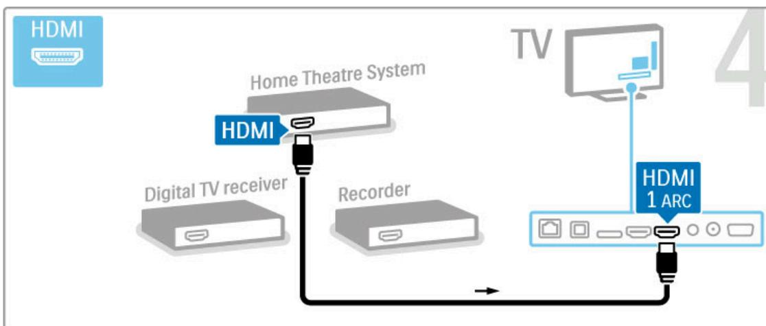
Se non si utilizza il collegamento HDMI-ARC sul televisore e il dispositivo, aggiungere un cavo audio digitale (ottico).
