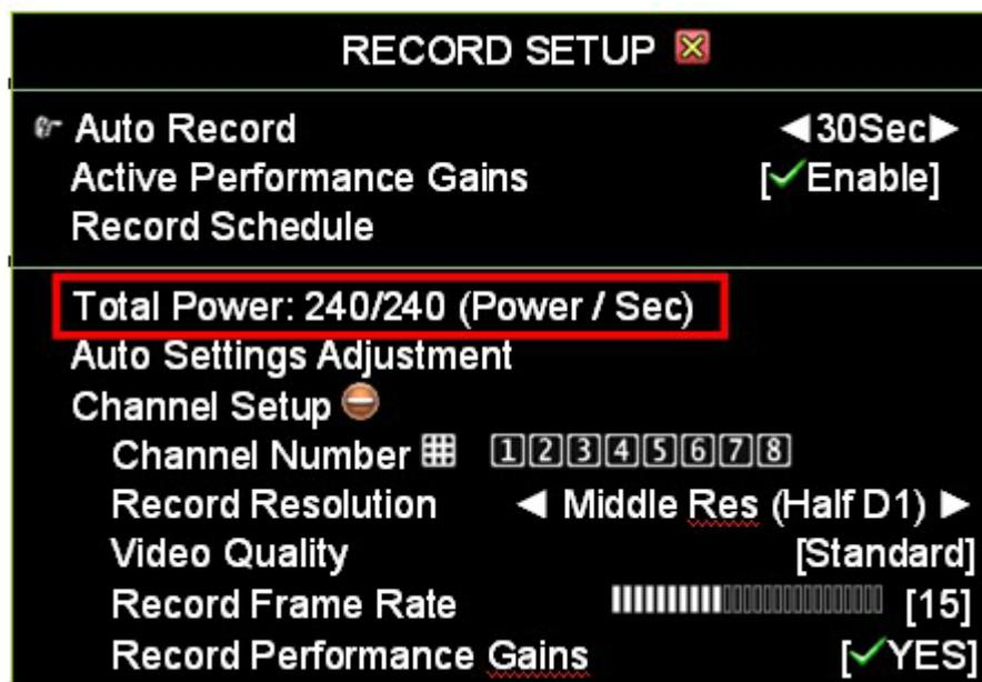
Per distribuire la capacità di registrazione in 4 canali fare clic sulla capacità totale (evidenziata da un bordo rosso nella figura).
