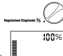
Per visualizzare i nuovi tempi d'irrigazione, basterà ruotare il selettore su **TEMPI D'IRRIGAZIONE**. Il display del tempo d'irrigazione terrà conto della regolazione stagionale.
