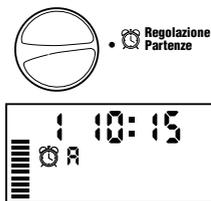
**NOTA:** la scelta di un tempo di avvio fa partire la sequenza d'irrigazione di tutte le stazioni. Pertanto è inutile programmare una partenza per ogni stazione. I tempi di avvio multipli di un programma possono essere usati per cicli d'irrigazione distinti la mattina, il pomeriggio o la sera. Le partenze possono essere inseriti in qualsiasi ordine. L'X-Core li ordinerà in modo automatico.
