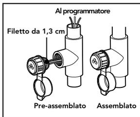
3. Avvitare l'alloggiamento del fascio di cavi SmartPort al raccordo a "T", come illustrato.
