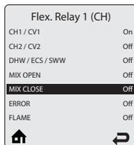
Selezionando **Mix Close**, viene attivato il relé per il consenso di chiusura della valvola miscelatrice. Il tempo di chiusura di default è 120 sec.
