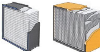
Le cappe Esco utilizzano i filtri a minipieghe senza separatori in alluminio della ditta svedese Camfil Farr® per migliorare l'efficienza del filtro, prolungarne la durata e ridurre la possibilità di perdite. I filtri hanno un telaio in alluminio leggero per garantire la stabilità strutturale ed eliminare il rigonfiamento tipico dei telai in legno tradizionali.
