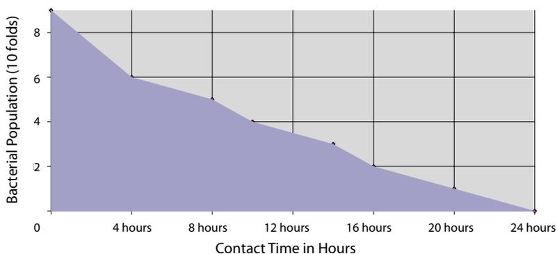
Le superfici esterne sono trattate con il rivestimento antimicrobico Esco Isocide™ per prevenire la contaminazione delle superfici e inibire la crescita di batteri. Isocide è integrato nel rivestimento stesso e non viene rimosso neppure dopo ripetuti lavaggi. Tutti i risultati dei Test sono disponibili su richiesta.
