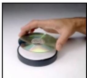
Tenendo il CD per i bordi, posizionarlo sul rilievo centrale del dispositivo. **• IL LATO DATI VERSO L'ALTO!**
