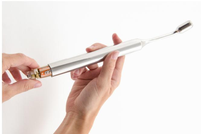
4. Tenere ferma la sonda; spingere il coperchio della batteria nella sonda e ruotare in senso orario finché l'anello di tenuta non è più visibile.
