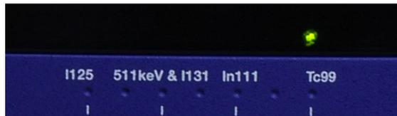
Sui sistemi Navigator GPS prodotti prima di questa data (tra il 1999 e il 2006) l'indicatore dell'isotopo non è presente ed è quindi necessario controllare la parte posteriore dell'unità di controllo per verificare che l'impostazione dell'isotopo sia la stessa selezionata sul ricevitore.
