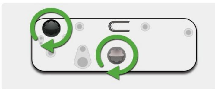
4. Ruotare la manopola grigia in senso antiorario finché i fasci non si trovano simmetricamente sullo stesso livello.
