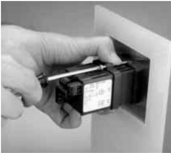
Figura 6a - Installazione del regolatore.
