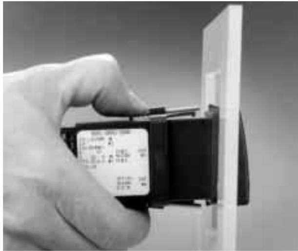
Figura 6b - Rimozione del regolatore.
