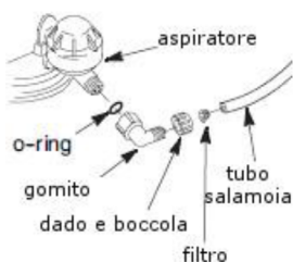
Figura 8 - Collegamento tubo salamoia
