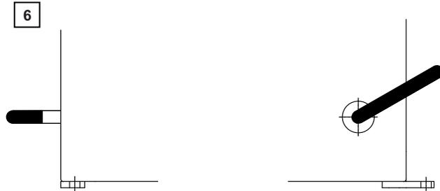
Consente il rilascio del fissaggio della ruota sulla flangia. **Non azionare durante il ciclo della macchina e/o quando vengano montate flange differenti da quella a coni standard.**
