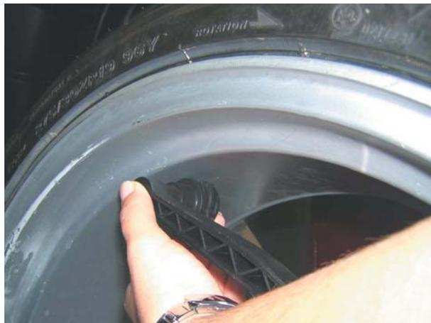
Premere il pulsante **ENTER** e ruotare lentamente a mano la ruota mantenendo una pressione costante sulla pinza fino alla visualizzazione del seguente quadro :
