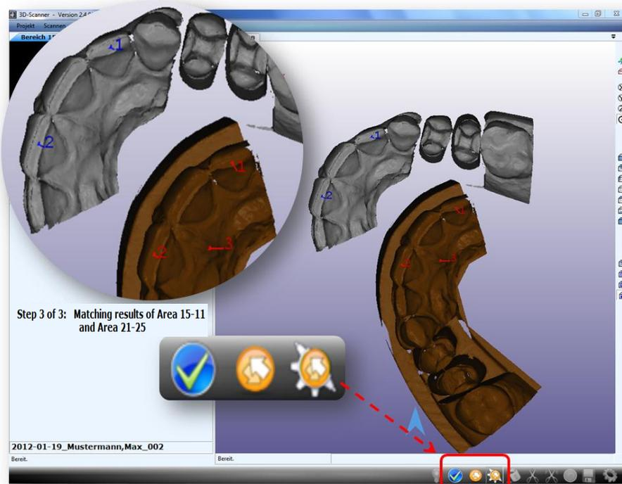
Piazzando l'ultimo punto sulla seconda scannerizzazione i settori di scannerizzazione vengono posizionati reciprocamente tramite il software.
