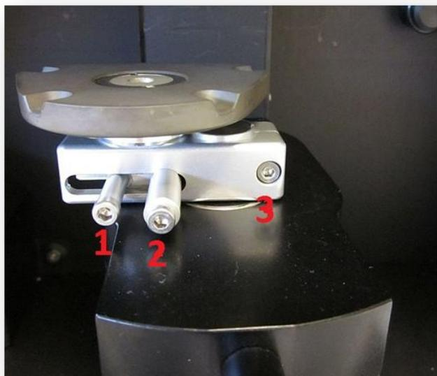
La vite **1** consente la regolazione continua in altezza e la rotazione del modello. **Accertarsi che anche in condizione rialzata sia garantita ancora una sufficiente stabilità.**
