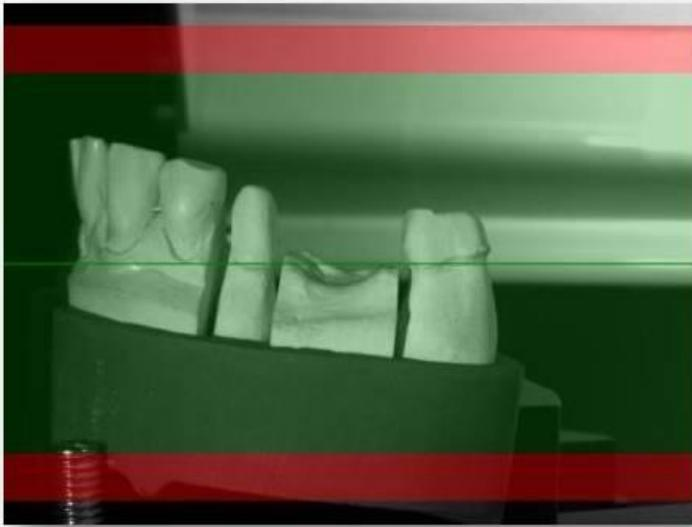
Muovere il supporto oggetti con il modello di ca. 25° verso destra in senso antiorario e verificare nell'immagine dal vivo della camera se l'area da scannerizzare è stata rilevata correttamente.
