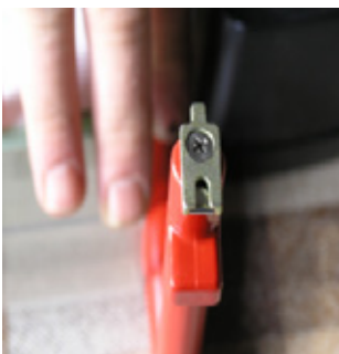
Immagine 25: Chiave per smontare le ante delle finestre
