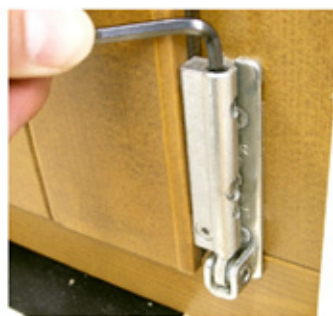
Immagine 18: Regolazione della finestra in altezza (cerniera in basso)
