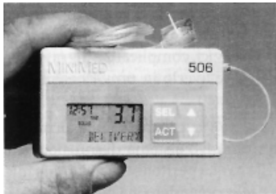
Microinfusore per l'infusione continua sottocutanea di insulina pronta.
