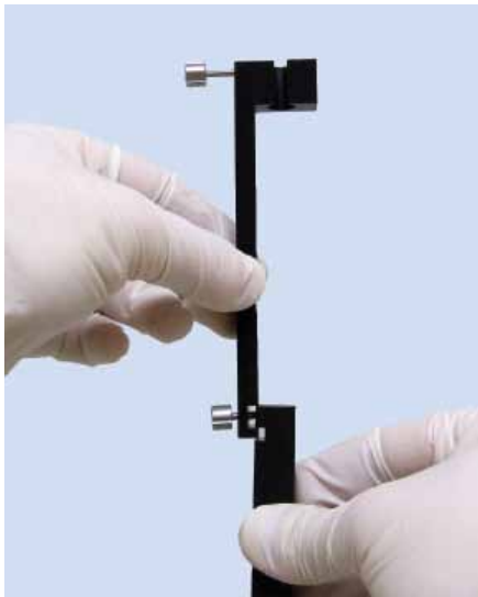
1. Attaccare il portaelettrodo al misuratore.
